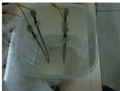
รูป 4 การติดตั้งเซนเซอร์ตรวจวัดระดับน้ำ
