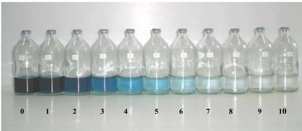
รูปที่ 1 ชุดเปรียบเทียบมาตรฐานระดับสีอะมิโดแบล็ค กำหนดให้ 0 เป็นค่าความเข้มสีน้ำเงินเข้มในตอนต้น เจือจางครั้งละ 2 เท่า จนกระทั่งถึงระดับ 10 เป็นค่าความเข้มสีเมื่อไม่มีสีน้ำเงินเข้มของสีอะมิโดแบล็ค
