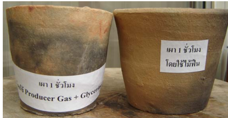
รูป 5 ผลิตภัณฑ์เครื่องปั้นดินเผาที่ผ่านการเผา 1 ชั่วโมง
