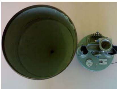
รูป 2 เครื่องวัดปริมาณน้ำฝนแบบถ้วยกระดก (Tipping bucket)
