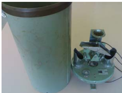
รูป 2 เครื่องวัดปริมาณน้ำฝนแบบถ้วยกระดก (Tipping bucket)
