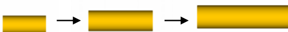
รูป 9 ก อนุภาคเริ่มเกิดการยึดตัวไปในทิศทางการขึ้นรูป (สอดคล้องกับ \eta=3 )
